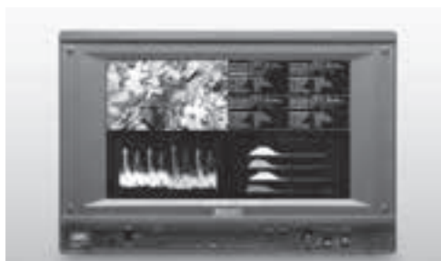
写真4 4K映像、波形モニター
