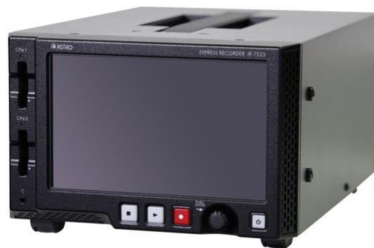
快速录像机 IR-7523 是一款针对视频制作领域高帧率化、高分辨率化的需求而开发的便携式录像机。搭载 CFexpress 记录单元, 单机可实现 4K120p 视频的录制播放。IR-7523 支持收录视频的慢放 (同时输出 4K/HD), 可提高 4K 摄像机的机动性。此外, 多台连接可实现 4K240p 以及 8K60p 等更高分辨率和帧率叠加的录制播放。\*1
