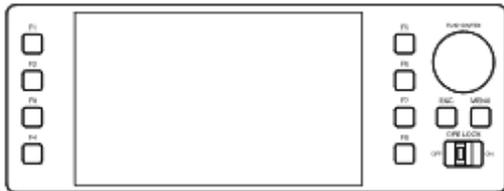
メニュー画面の操作は、本装置前面の MENU ボタン、ジョグダイヤル、および ESC ボタンを使用して行います。
